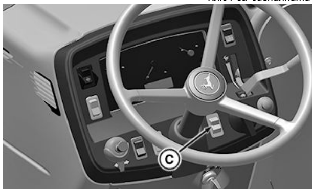
Ключ за сигналната лампа при 5050E
