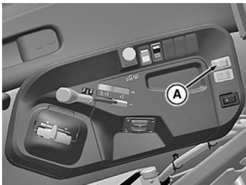
Ключ за работния фар при 5058E, 5067E, 5075E
