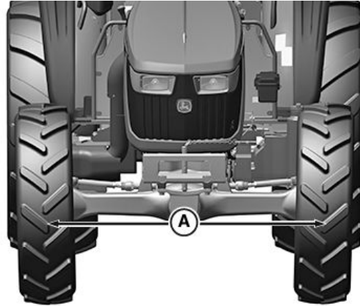
A—Distância de Convergência do Eixo da Tração Dianteira
