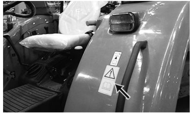
No Para-Lama Esquerdo—Estação do Operador Aberta Isolada
