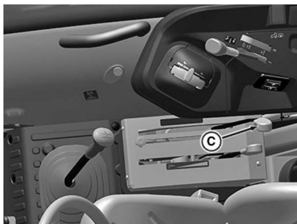
Dźwignia sterująca do izolowanego stanowiska operatora bez kabiny, 5058E, 5067E i 5075E
