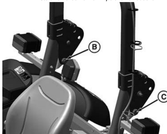
Zainstalowanie śrub i nakrętek
