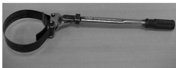
Hidraulinio filtro išėmimo / derinimo įrankis
