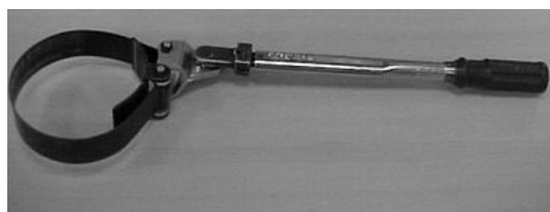
Hidrauliskā filtra noņemšana / instrumenta uzstādīšana
