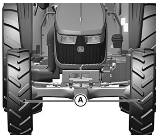
A—Distanza convergenza assale per trazione anteriore
