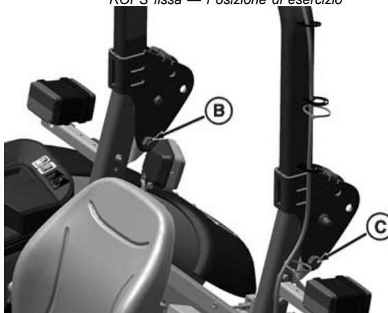
Installazione dei bulloni e dei dadi
