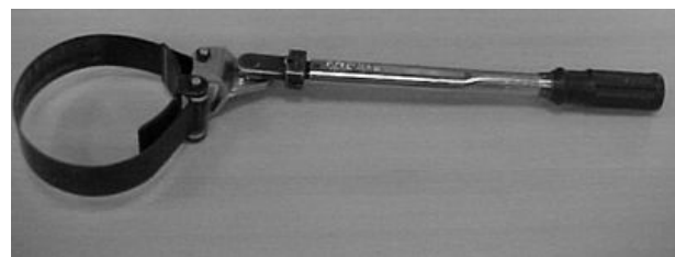
Aus- und Einbauwerkzeug für Hydraulikfilter
