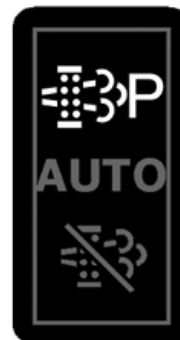
Schalter für Abgasfilterreinigung - Modus bei geparkter Maschine
