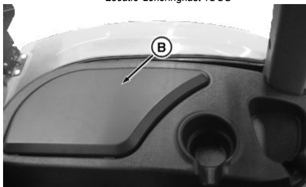
Locatie zekeringkast cabine
