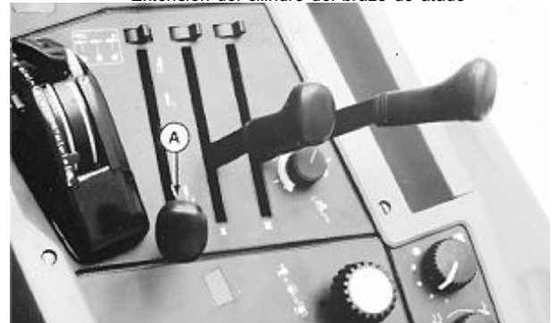
Retracción del cilindro del brazo de atado
