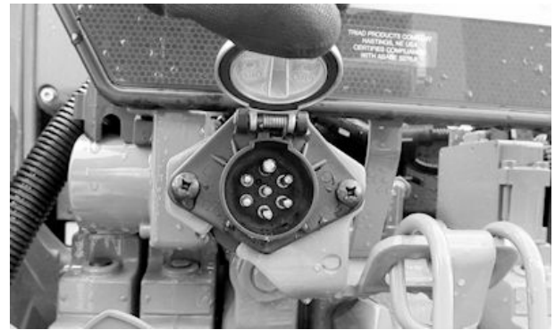
Toma de siete terminales del tractor
