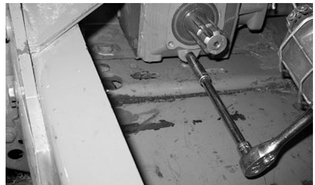
Retiro del tapón de vaciado
