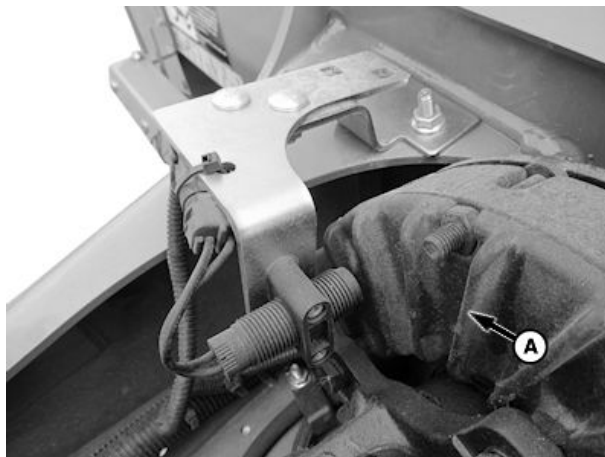
Visualización del sensor de la TDF (540 r/min)
