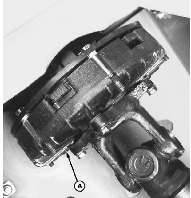
Se muestra el eje de transmisión 540 r/min
