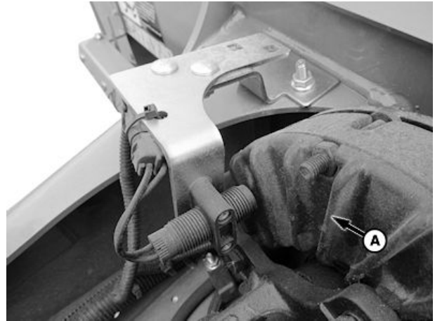
Visualización del sensor de la TDF (540 r/min)
