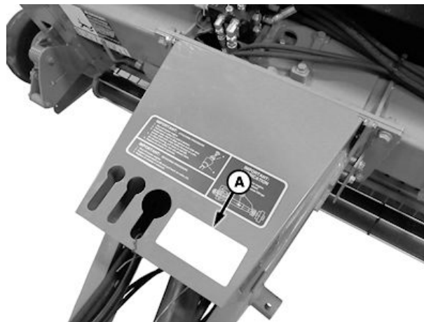
Cubierta de la TDF
