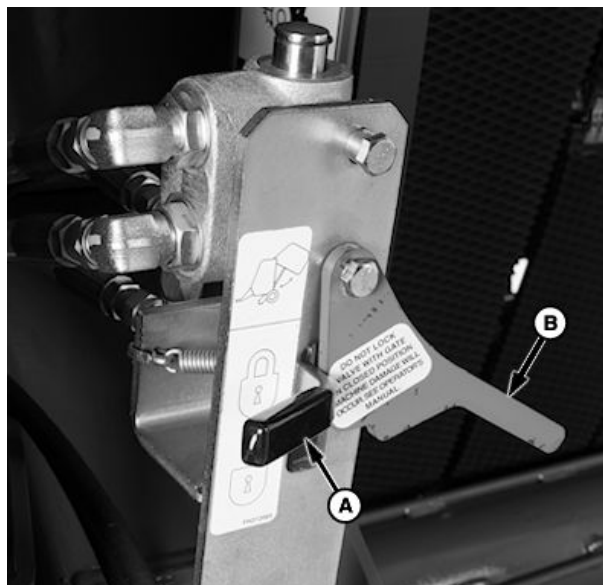
A—Palanca de bloqueo del portón
