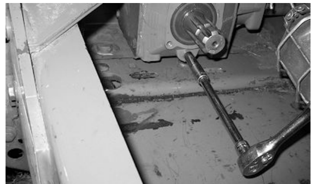
Retiro del tapón de vaciado
