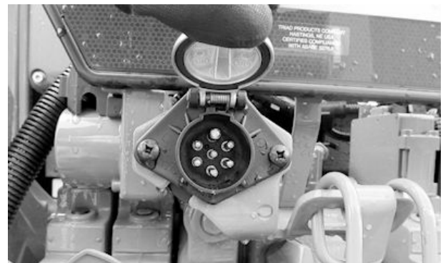
Toma de siete terminales del tractor
