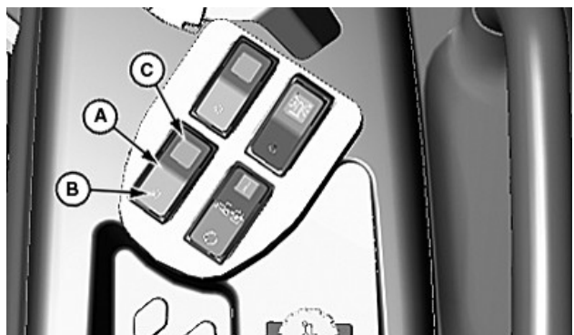
LV29486—UN—11OCT17 Contacteur de débit continu du troisième distributeur auxiliaire illustré, tracteur série M (HST uniquement)
