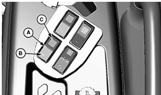
Contacteur de débit continu du troisième distributeur auxiliaire illustré, tracteur série M (HST uniquement)
