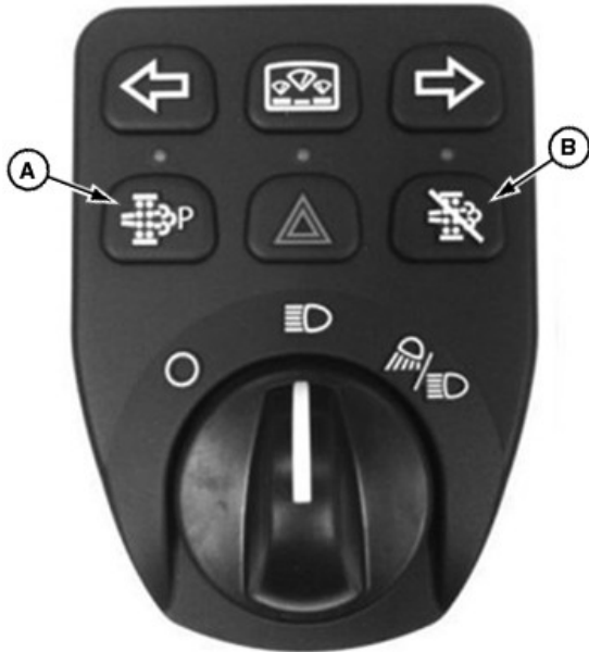
A—Interruptor de limpieza en estacionamiento B—Interruptor de desactivación de limpieza
