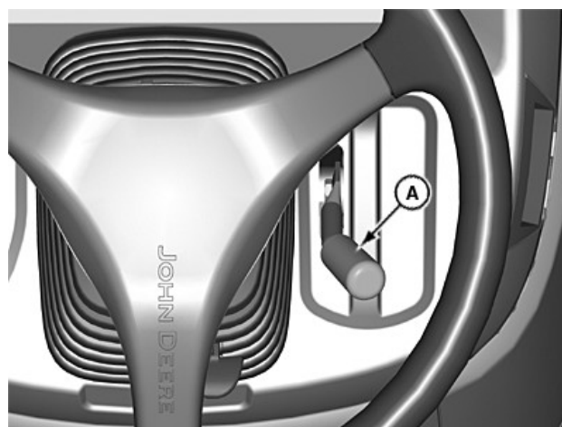
Palanca del acelerador (se muestra la plataforma de conducción abierta)
