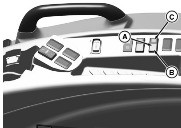
Se muestra el interruptor de la válvula de mando a distancia del tractor de la serie M (solo transmisión hidrostática)
