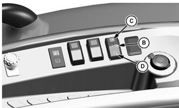
Interruptor de la válvula derivadora; plataforma de conducción abierta
