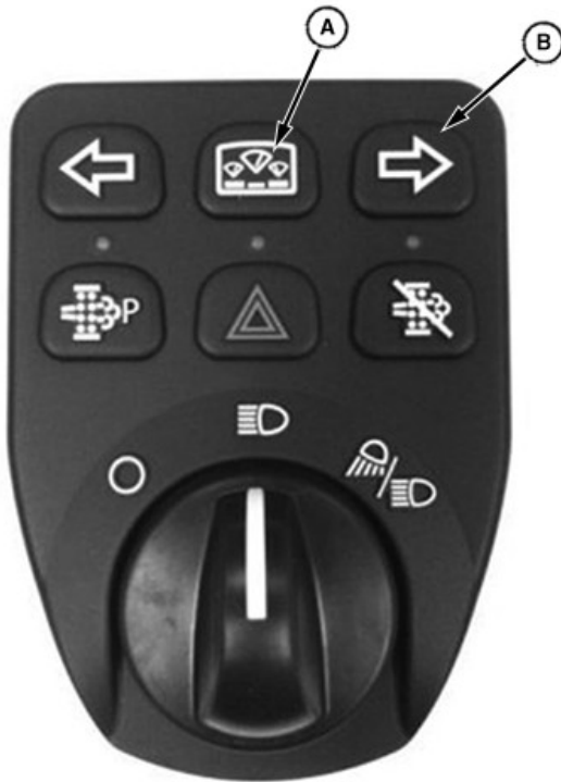
A—Interruptor de modo de visualización B—Interruptor de giro a la derecha
