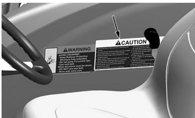
Guardabarros derecho - Tractores con estructura protectora contra vuelcos plegable
