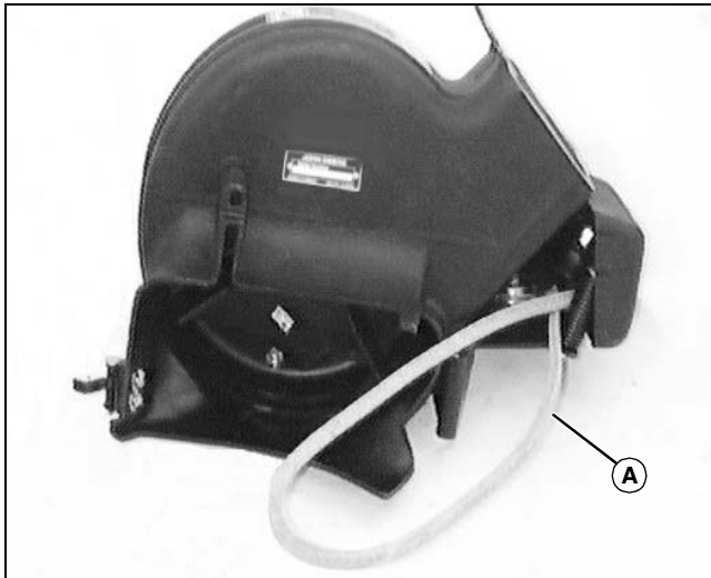
Abbildungshinweis: Gekreuzter POWER FLOW Riemen (A)
