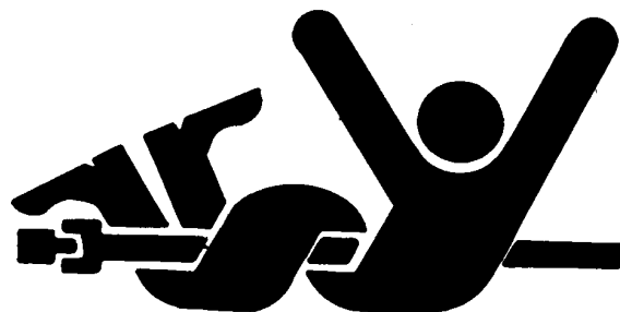
Attention aux arbres de transmission rotatifs
