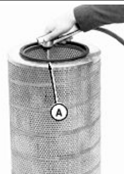
Очистка элемента грубой очистки
