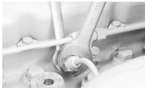
Выпуск воздуха из топливной системы через нагнетательную форсунку
