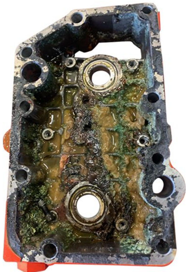
Последствия длительного хранения охлаждающей жидкости — более одного года
