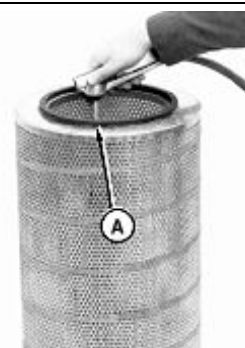
Limpeza do Elemento Primário
