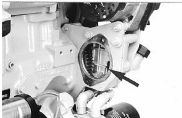
Transmissão Auxiliar por Engrenagens
