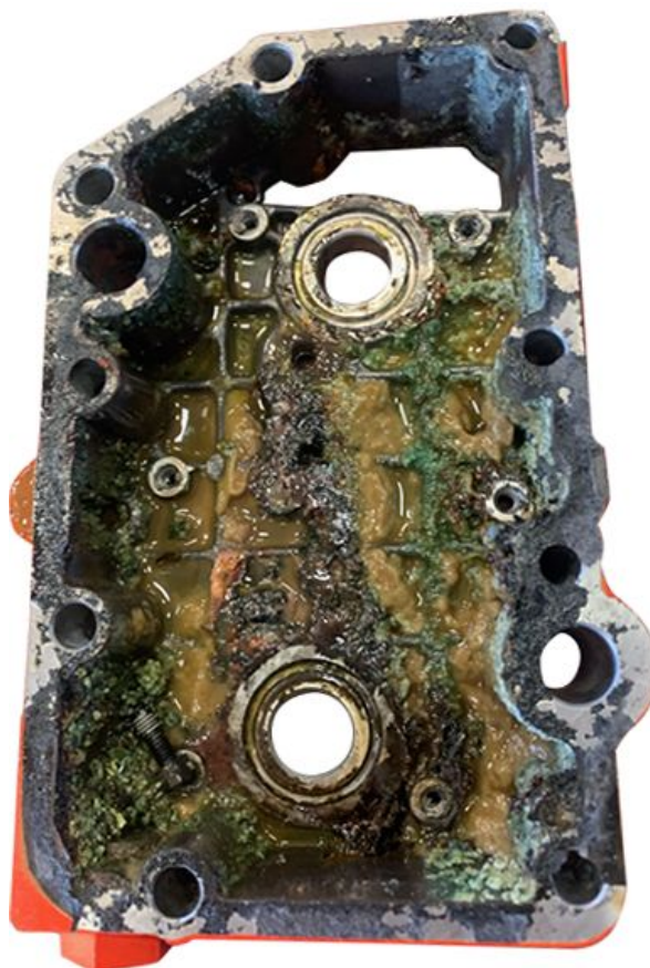
Efeitos do Armazenamento Prolongado do Líquido de Arrefecimento — Mais de Um Ano
