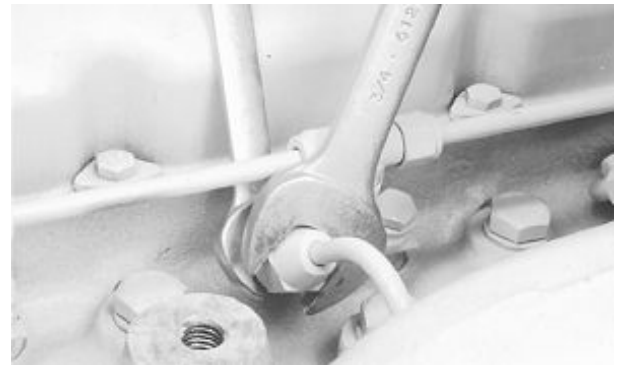
Sangria do Sistema de Combustível no Bico Injetor
