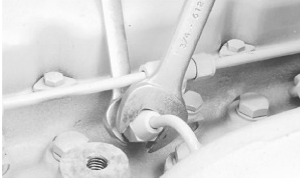
تنفيس نظام الوقود في فوهة الحقن.
