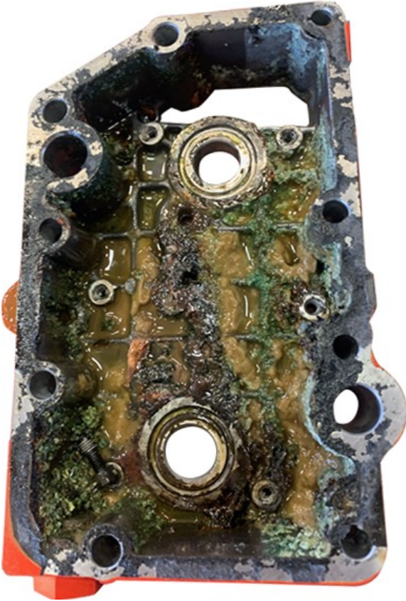
تأثيرات التخزين الطويل لسائل التبريد — أكثر من سنة
