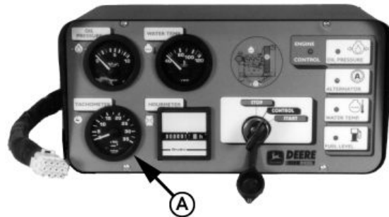
Toerenteller AEZ instrumentenpaneel
