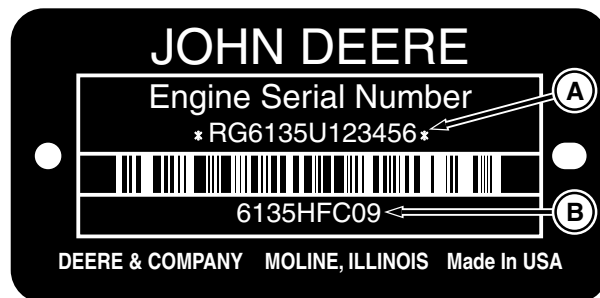
Tabliczka z numerem seryjnym silnika/danymi zastosowania RG33180 —UN—18NOV20
