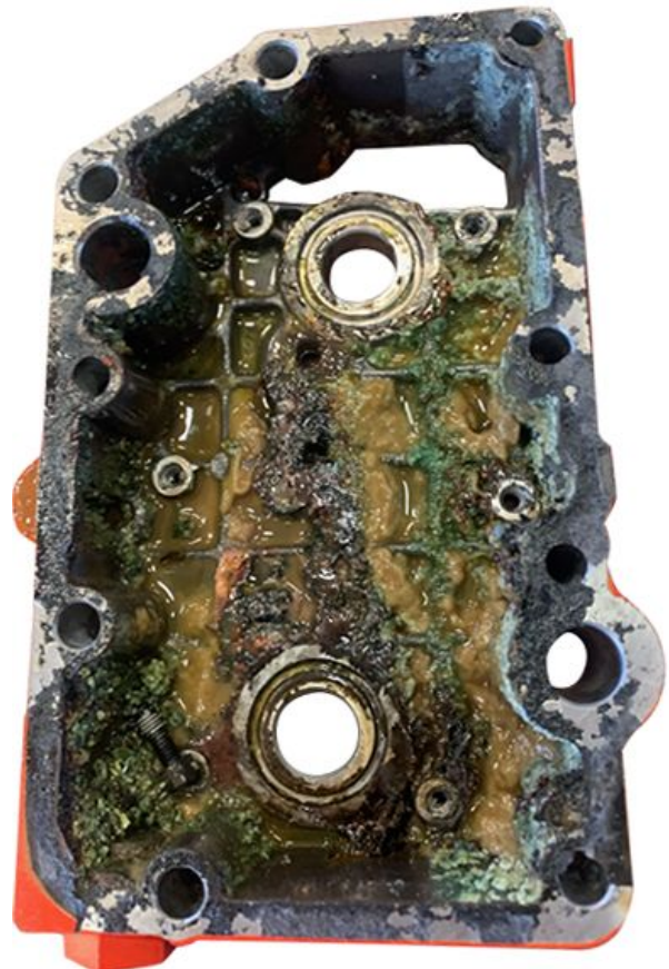
Auswirkungen langer Lagerzeiten auf das Kühlmittel — länger als ein Jahr
