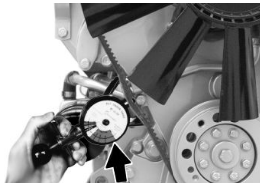
Sprawdzanie naciągu pasów wskaźnikiem naciągu
