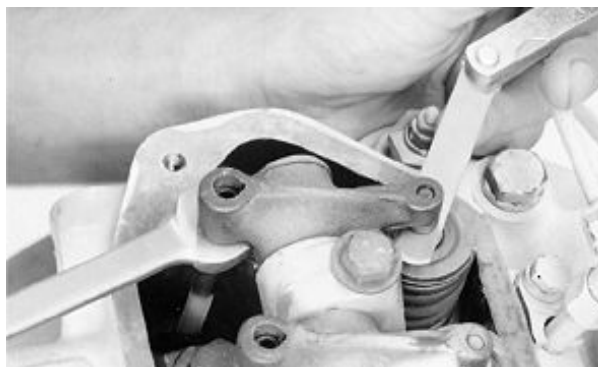
Sprawdzenie luzu zaworowego
