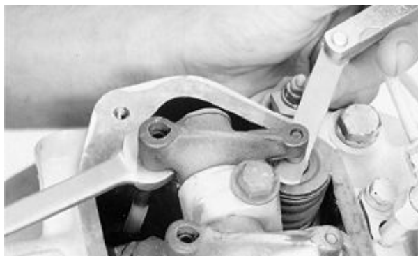
检查气门间隙
