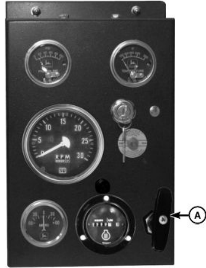
北美机型仪表板上的油门手柄
