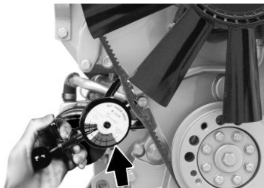
用张力计检查皮带张力
