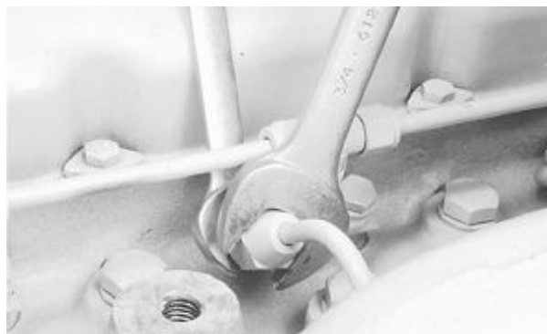
喷油嘴处燃油系统放气
