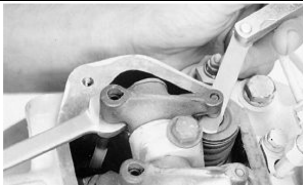
Comprobación de la separación de las válvulas
