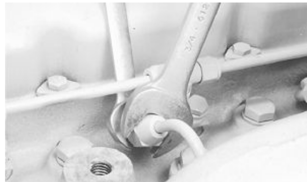
Entlüften des Kraftstoffsystems an der Kraftstoffeinspritzdüse
