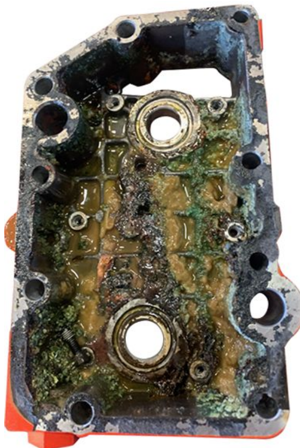
Auswirkungen langer Lagerzeiten auf das Kühlmittel — länger als ein Jahr
