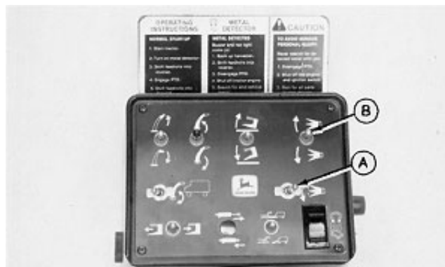
A—Переключатель (Вкл/Выкл) B—Переключатель (блокировка)
