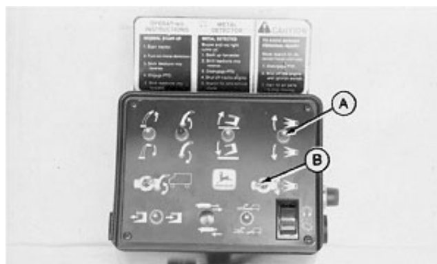
A—Переключатель (Вкл/Выкл) B—Переключатель (блокировка)
