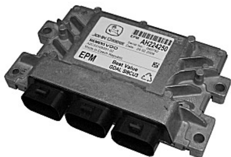
Módulo de alimentación electrónico de RowCommand™
