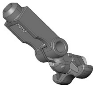
A66614—UN—22FEB10 Sensor de contrapresión de rueda auxiliar
