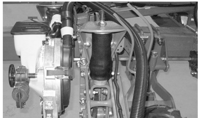
Muelle neumático enrollado correctamente (sembradoras de hileras dobles)
