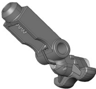
A66614—UN—22FEB10 Sensor de contrapresión de rueda auxiliar
