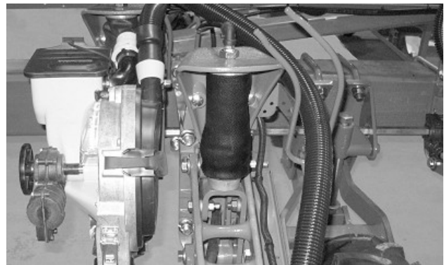
Muelle neumático enrollado correctamente (hilera doble)
