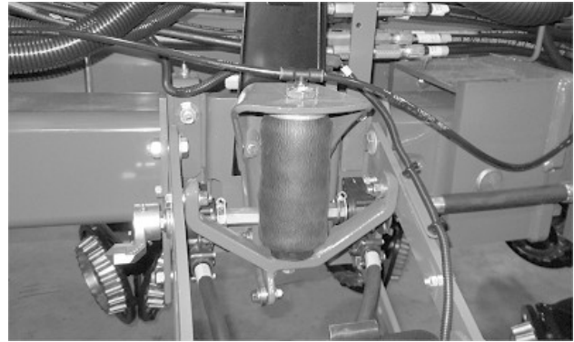
Muelle neumático enrollado correctamente sobre el montaje inferior
