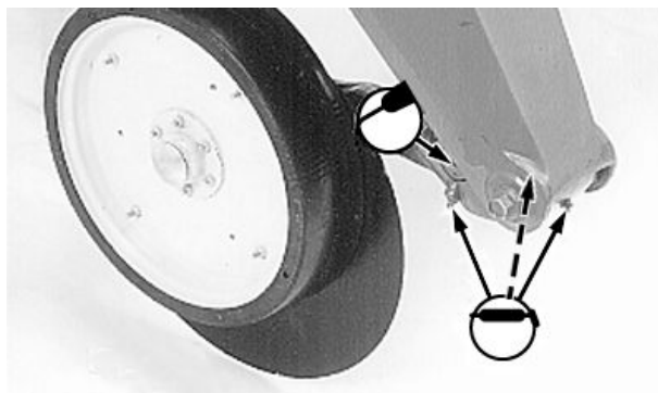
Однодисковый сошник для внесения удобрений
