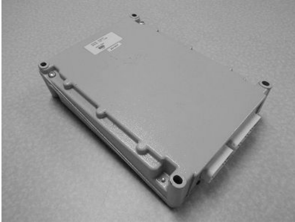
Контроллер внесения удобрений с переменной скоростью
