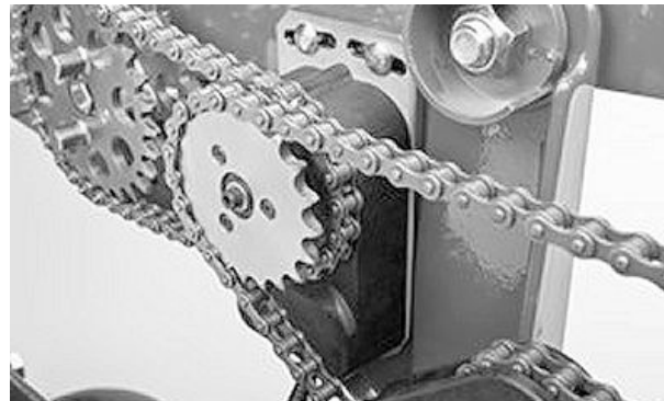
Муфта RowCommand™ с цепным приводом MaxEmerge™
