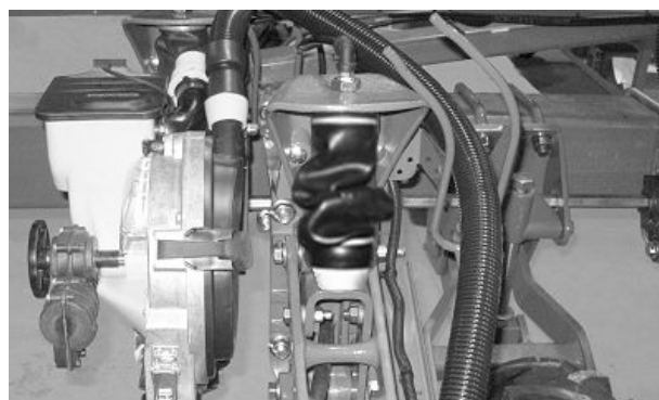
Неправильно расправленная пневматическая пружина (сеялки двухрядного посева)
