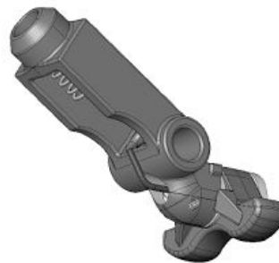
Датчик прижима копирующего колеса
