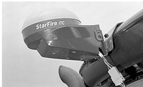
Приемник глобальной системы позиционирования (GPS)
