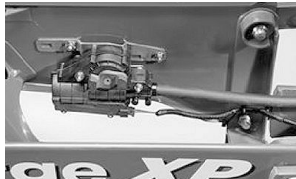
Муфта RowCommand™ с валом MaxEmerge™ Продолжение на следующей стр. OUO6064,00001AA -59-20JUL10-2/4
