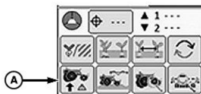
Кнопка прижима (активный PDF с двумя датчиками)
