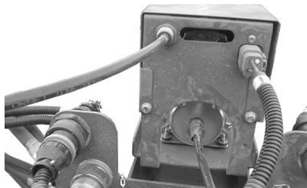
Воздушный компрессор пневматического прижима (машины с встроенным пневматическим прижимом с одной уставкой)
