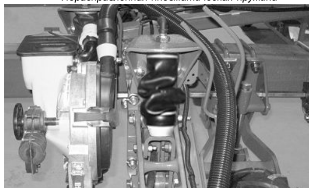
Неправильно расправленная пневматическая пружина (двухрядный посев)
