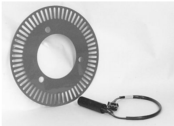
Датчик движения колеса для регулируемого привода
