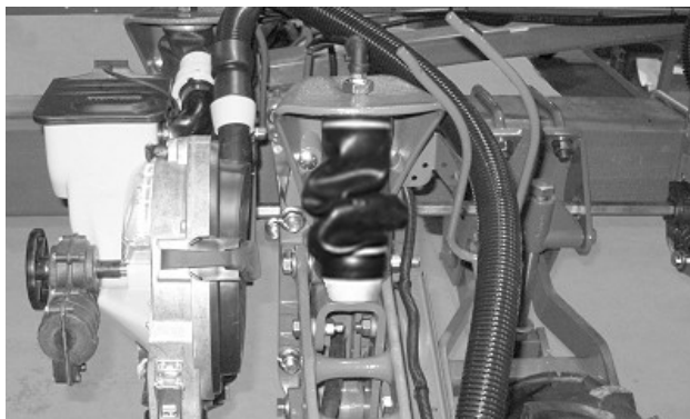
Neppravilno omotana zračna opruga (sijačice dvostrukog reda)
