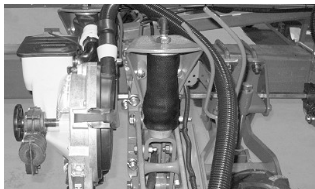
Pravilno omotana zračna opruga (sijačice dvostrukog reda)
