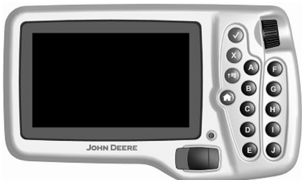
GreenStar™ 1800 monitor s kontrolnom pločom
