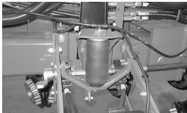
Pravilno omotana zračna opruga preko donjeg nosača
