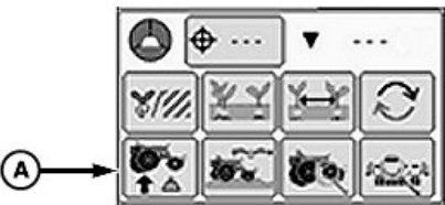
Andruckkraft-Schaltfläche (pneumatische Andruckkraft mit einem Sensor)
