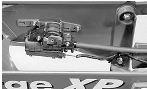
MaxEmerge™ XP Pro-Shaft™-Kupplung
