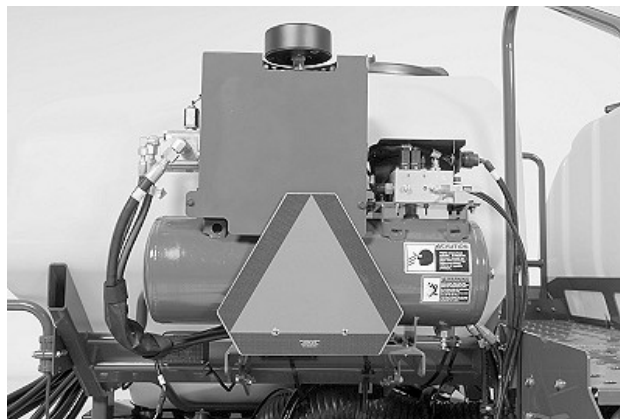
A72531—UN—12SEP11 Luftkompressor, Druckluftbehälter und Magnetsteuerventil für pneumatische Andruckkraft – gezogene Sämaschinen mit CCS
