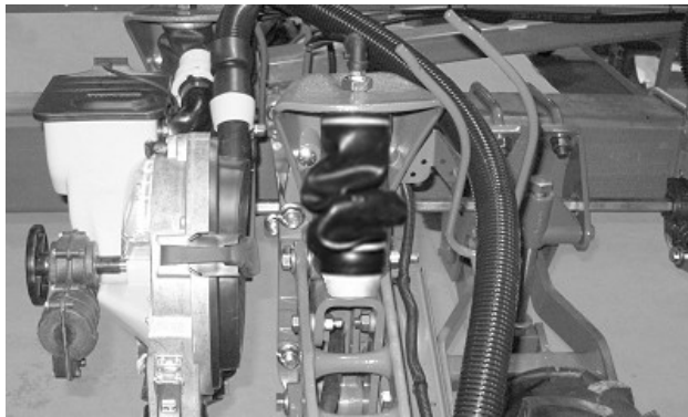
Unvorschriftsmäßig gerollte Luftfeder (Doppelreihe)
