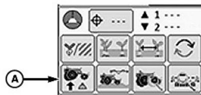
Andruckkraft-Schaltfläche (pneumatische Andruckkraft mit zwei Sensoren)
