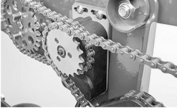
RowCommand™-Kupplung mit Kettenantrieb
