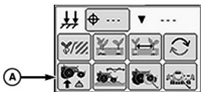
Andruckkraft-Schaltfläche (pneumatische Andruckkraft mit einem Sollwert)
