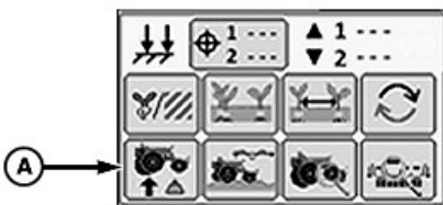
Andruckkraft-Schaltfläche (pneumatische Andruckkraft mit zwei Sollwerten)
