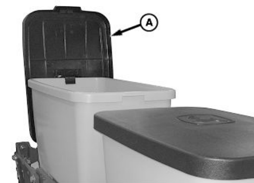
Семенной ящик емкостью 58 л (1,6 бушеля)
