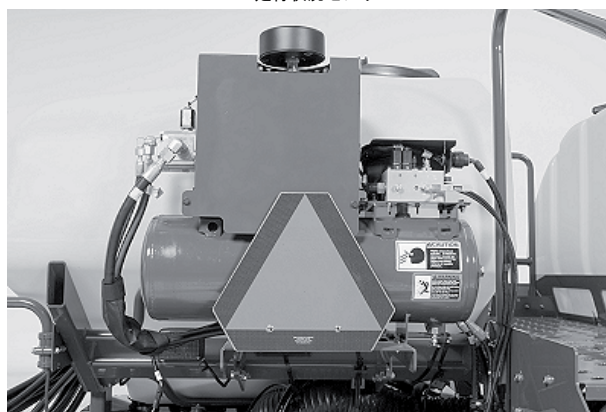
空気圧式下向き力エアコンプレッサ、エアタンク、ソレノイド制御弁：牽引式播種機 CCS (アクティブ下向き力) 付き
