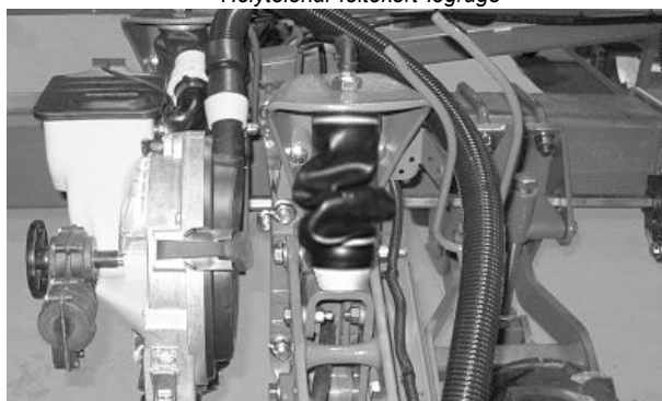
Helytelenül feltekert légrugó (kétsoros)
