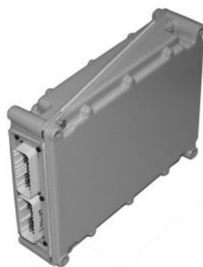
Második vetőmonitor/változtatható sebességű hajtás vezérlőegység 24-nél több soros munkagépeknél
