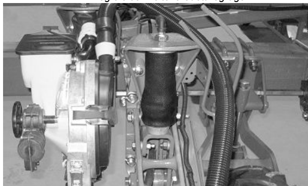
Megfelelően feltekeredett légrugó (kétsoros)
