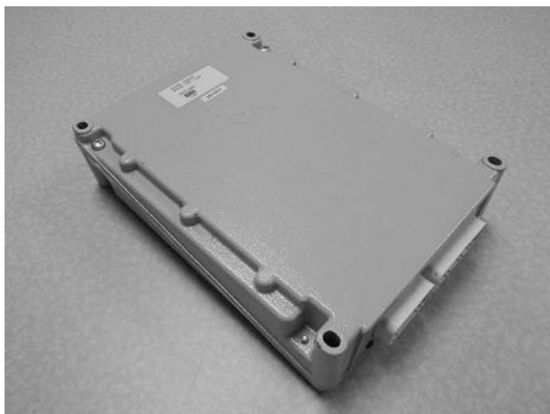
Contrôleur d'engrais à dose variable
