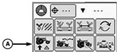
Bouton Pression vers le bas (pression pneumatique vers le bas à un capteur)
