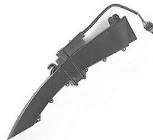
Tube à semence avec capteur de semence
