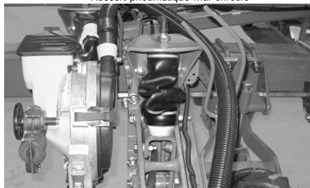
Ressort pneumatique mal enroulé (rangs jumelés)
