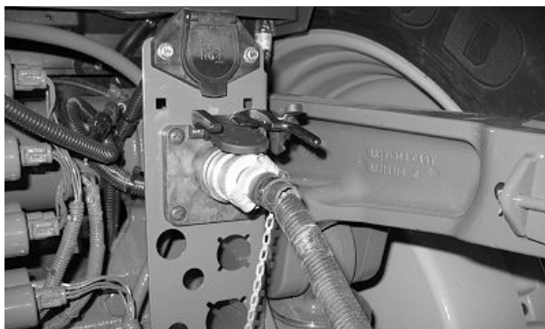
Connexion de faisceau CAN
