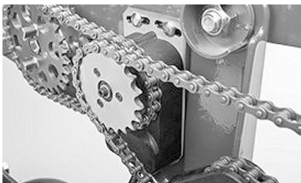
Embrayage RowCommand™ à chaîne MaxEmerge
