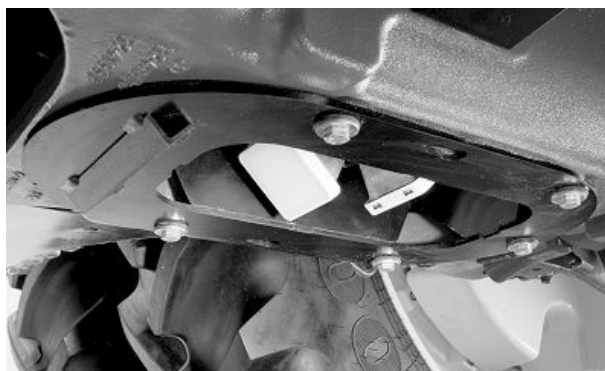
Radar à faisceau double John Deere
