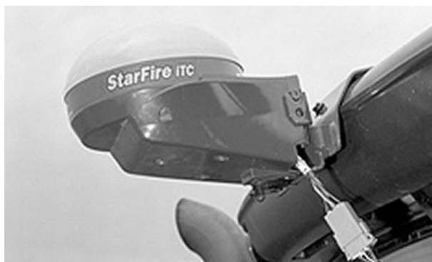
Récepteur GPS (système de positionnement par satellites)
