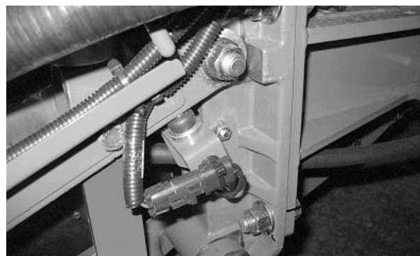
Capteur de hauteur des bras parallèles pour semoirs portés à rangs jumelés
