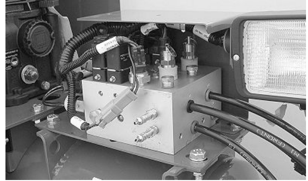
Capteurs de pression pneumatique vers le bas (pression active vers le bas) (électrovanne à point de consigne double en illustration)
