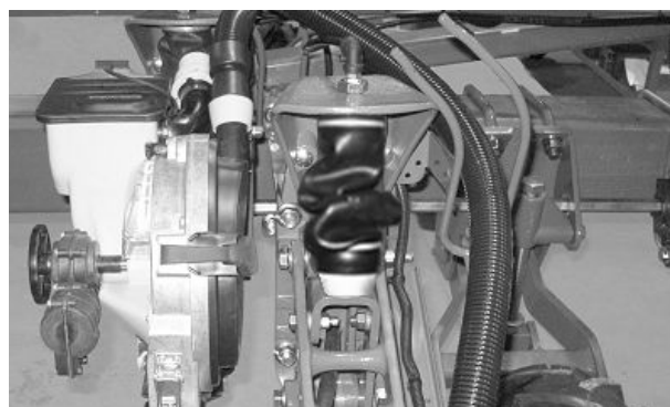
Ressort pneumatique mal enroulé (semoirs à rangs jumelés)
