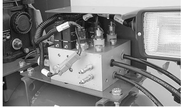
Sensores de presión de contrapresión neumática (Contrapresión activa) (Se ilustra la válvula con punto de ajuste doble)
