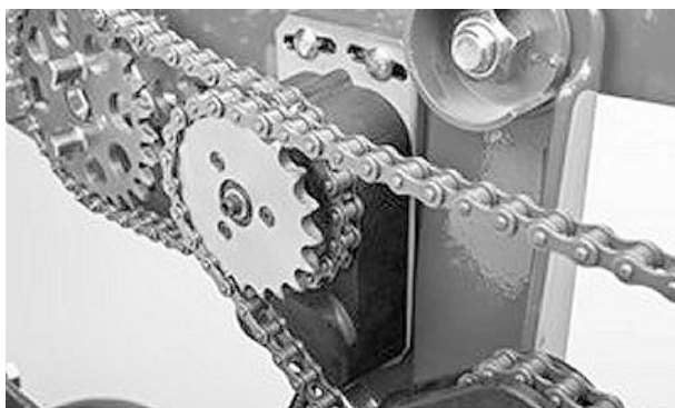
Embrague de una unidad RowCommand™ accionada con cadena en un sistema MaxEmerge
