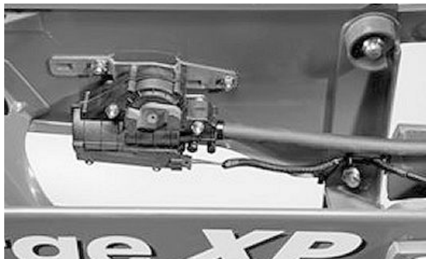
Embrague de una unidad RowCommand™ accionada por Pro-Shaft en un sistema MaxEmerge™
