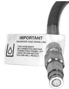
Punta de manguera de vaciado de caja de superficie plana
