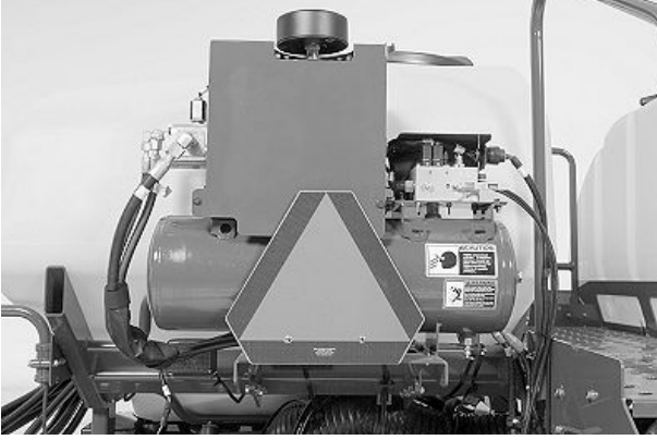
Pnömatik Düşey Kuvvet Hava Kompresörü, Hava Deposu ve Solenoid Kumanda Valfi - CCS'li, Çekilen Ekim Makineleri (İkili Ayar Noktası ve Etkin Düşey Kuvvet)
