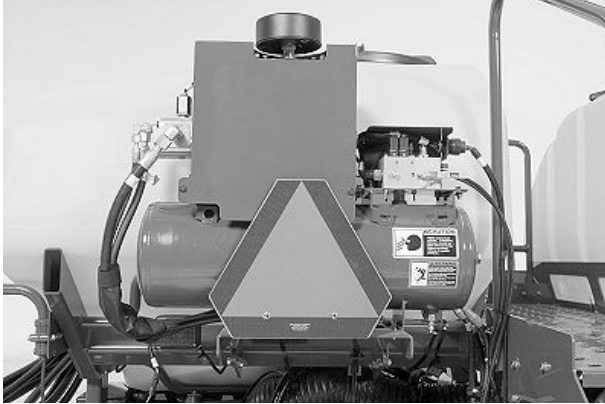
Válvula Solenoide de Controle, Tanque de Ar e Compressor de Ar da Força Descendente Pneumática - Plantadeiras Rebocadas com CCS (Ponto de Ajuste Duplo e Força Descendente Ativa)
