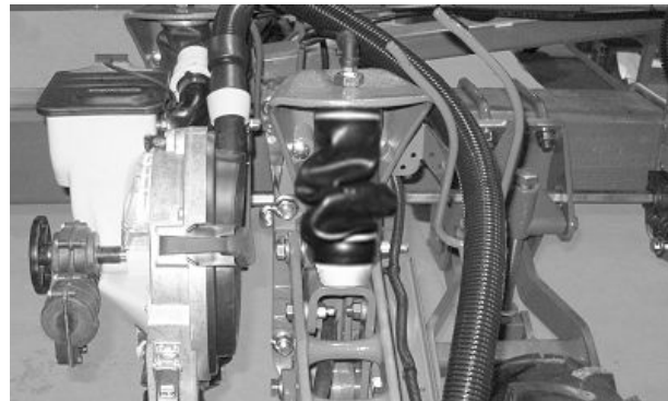
Nepravilno omotana zračna opruga (sijačice dvostrukog reda)
