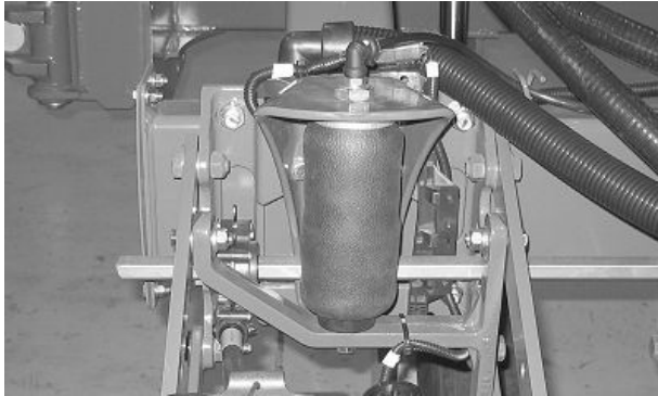
Pravilno omotana zračna opruga
