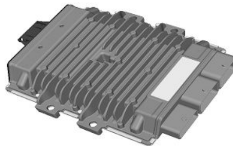
Glavni kontroler sijačice 2 (PM2)
