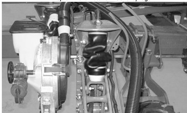
Nepravilno omotana zračna opruga (sijačice dvostrukog reda)
