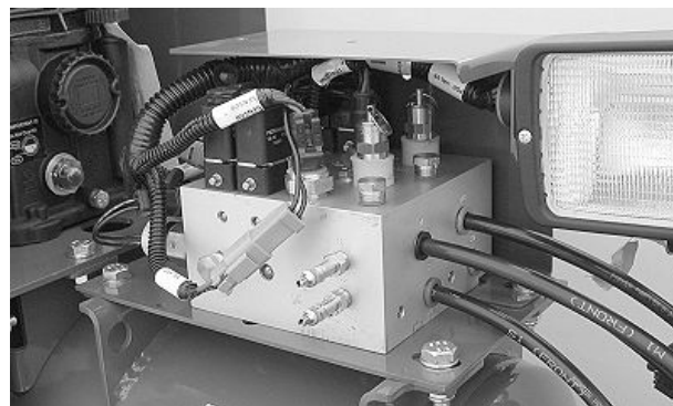
Senzori tlaka pneumatskog pritiskanja (aktivno pritiskanje) (prikazan je ventil s dvostrukom točkom postavljanja)
