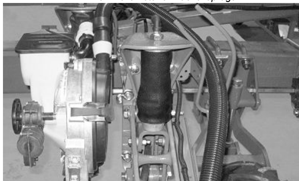
Pravilno omotana zračna opruga (sijačice dvostrukog reda)
