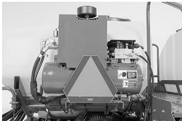
Compresor de contrapresión neumática, depósito de aire y electroválvula de control - Sembradoras remolcadas con CCS (punto de ajuste doble y contrapresión activa)
