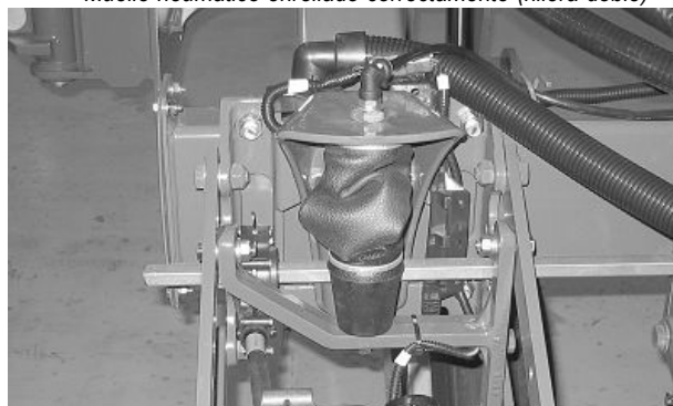
Muelle neumático enrollado incorrectamente
