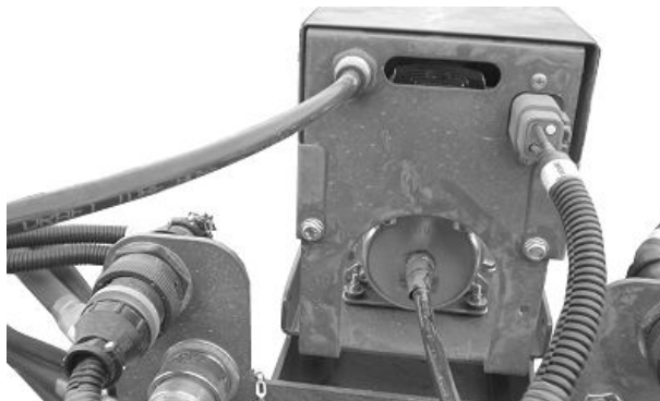
Compresor de aire de contrapresión neumática (máquinas con contrapresión neumática integrada con punto de ajuste único)
