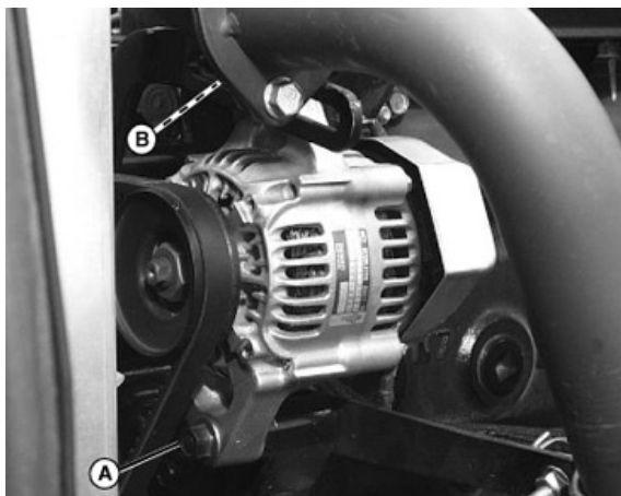
Dynamo på høyre side av motoren.
