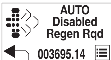
TCT012084—UN—26NOV14 Automatische reiniging vereist, regeneratie uitgeschakeld
