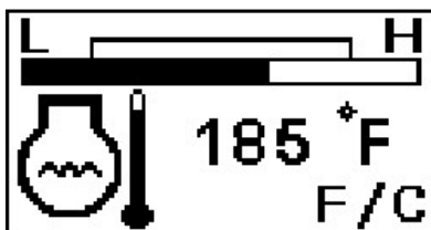
Écran de température du liquide de refroidissement moteur
