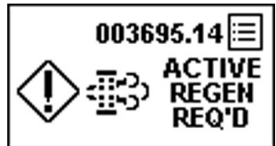
PY44599—UN—08SEP17 Se requiere la limpieza automática, regeneración desactivada
