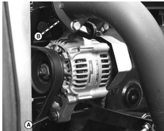
Alternador ubicado en el lado derecho del motor.
