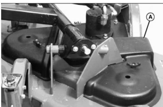
TCAL44929—UN—28MAR13 La plataforma delantera se muestra subida y la plataforma lateral bajada.
